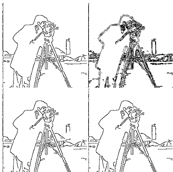
Obrázek 5. Ztenčení hran pomocí aproximačních násobiček. Nahoře vlevo je plně funkční řešení, nahoře vpravo je řešení využívající násobičku o pěti hradlech. Dole jsou řešení využívající násobičky o 255 hradlech vytvořené metodami S1 (zleva) a S2.
