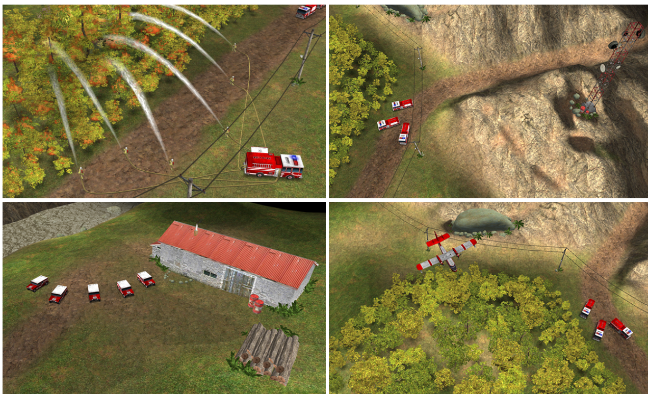
Obrázek 7. Scény optimalizované pro mobilní platformy – z původních jednotek snímků za sekundu na obou testovacích zařízeních došlo při použití optimalizačních technik ke zrychlení na průměrných 25 FPS u tabletu ThinkPad Tablet z roku 2011 a 60 FPS u první generace tabletu Google Nexus 7 z roku 2012.
