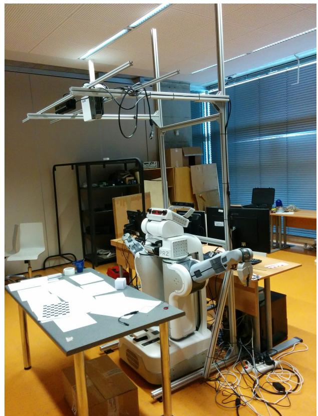
**Obrázek 6.** Konstrukce z hliníkových profilů osazená Kinectem a projektem
