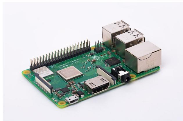
Obrázek 2. Jednodeskový počítač Raspberry Pi.
