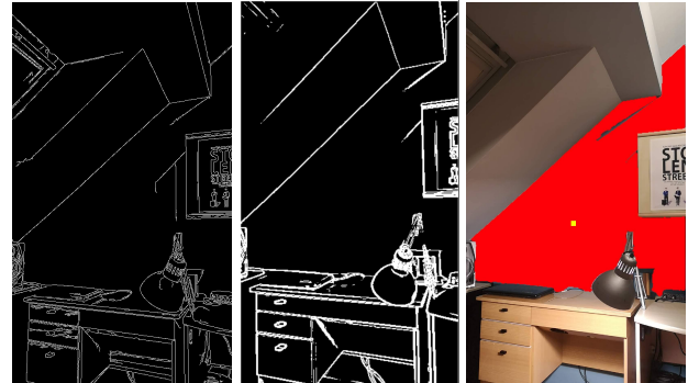
Obrázok 4. Porovnanie detektorov hrán. Vľavo: Canny edge detector. V strede: Sobel Operator. Vpravo: Sobel operator – vyplnenie úseku – finálne riešenie.
