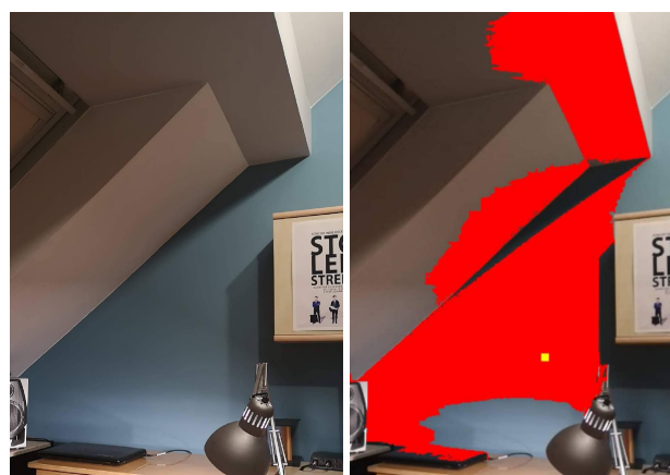
Obrázok 2. Vľavo: Pôvodný snímok z kamery. Vpravo: Nekvalitné rozpoznanie steny – porovnávanie zložky U a V.
