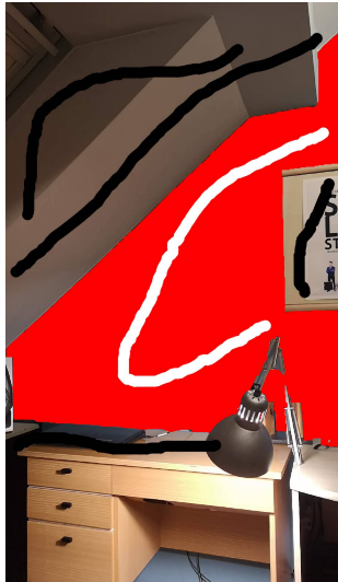
Obrázok 3. Rozpoznanie steny – algoritmus GrabCut s čiarami, ktorými užívateľ označil úsek steny.
