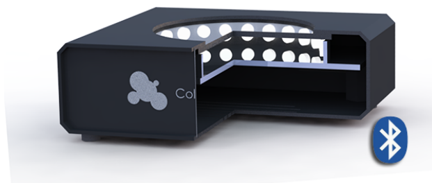
Obrázek 6. Řez modelem osvětlovací jednotky
