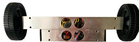
Obrázek 1. Jekly tvořící základ podvozku.
