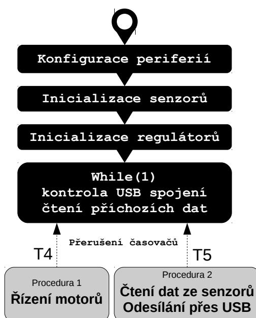
Obrázek 2. Schéma programu mikrokontroléru
