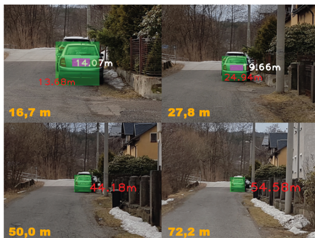
Obrázek 4. Příklad vyhodnocení na sadě referenčních fotek (Červený odhad je z detekovaného vozidla, bílý odhad je z detekované registrační značky a oranžovou barvou je znázorněna reálná vzdálenost)
