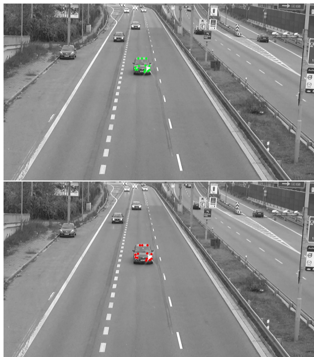
Obrázek 3. Nahoře snímek s vyhledanými trackovatelnými příznaky (zeleně, good features to track), dole odpovídající body na následujícím snímku vyhledané pomocí KLT trackeru (červeně)
