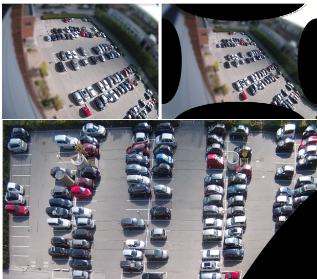
Obrázek 2. Původní snímek, snímek po odstranění distorze a snímek po odstranění perspektivy
