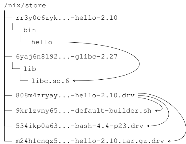
Obrázek 1. Objekty v /nix/store a závislosti mezi nimi. Pro lepší přehlednost jsou hashe v názvech objektů zkrácené a některé soubory jsou vynechané.
