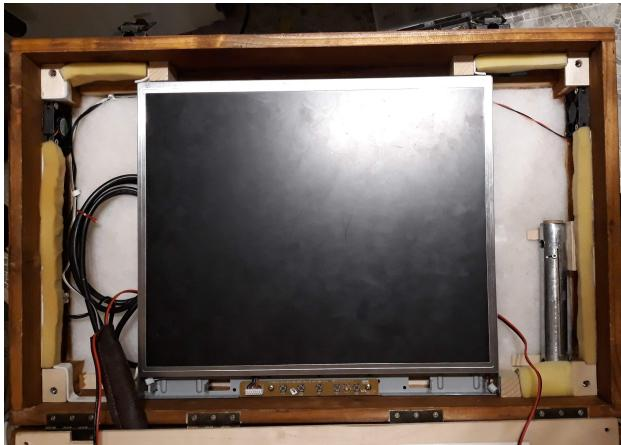
**Obrázok 1.** Vrchný diel kufra. V strede sa nachádza ukotvený monitor, po stranach vystlané plochy kvôli akustike a v pravo dole mechanizmus vyťahovacej nožičky. Po stranach sú ventilátory, zapojené opačným smerom za účelom lepšieho prúdenia vzduchu a vpravo hore sa nachádza teplotný senzor.
