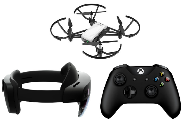
Obrázek 2. Komponenty navrženého systému pro vizualizaci letových dat dronu. Nahoře: Dron Tello Ryze. Vlevo dole: Brýle Microsoft Hololens 2. Vpravo dole: Bezdrátový ovladač pro Xbox One.
