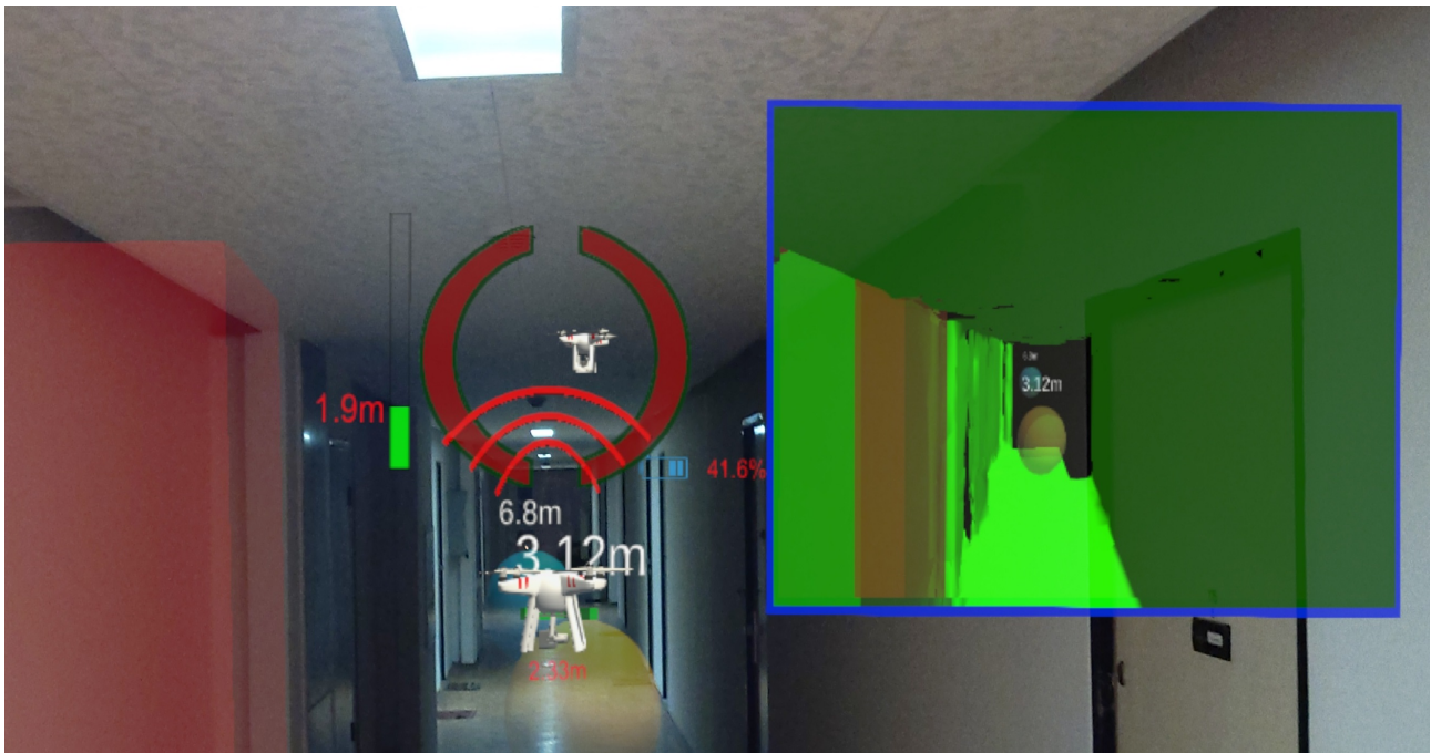
Obrázek 4. Detail vizualizace letových dat a informací o dronu. Uprostřed se nachází pilotovaný dron, kolem kterého se vykresluje terč, který ukazuje, kde v uživatelském pohledu se dron nachází. Nalevo od terče se nachází výškoměr, napravo malý indikátor baterie a obraz kamery. Pod terčem se nachází pomocný model dronu, který ukazuje aktuální natočení pilotovaného dronu, jeho vzdálenost od uživatele a indikátor nebezpečí.
