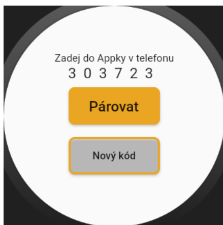
Obrázek 11. Obrazovka pro párování s uživatelským účtem. Po uživatelském testování byl původní záměr zadávat kód na hodinky vyhodnocen jako pro uživatele nepříjemný a to z důvodu špatného ovládání ve sportovních rukavicích.
