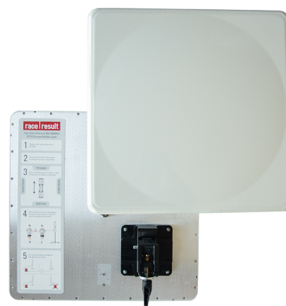
Obrázek 3. Anténa pro snímání čipů během závodu.
