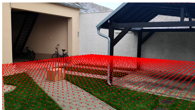
Obrázok 4. Vizualizácia roviny predstavujúcej zem. Pozície jednotlivých bodov boli zistené funkciou PnP. Konfigurácia využívala 11 bodov so známymi súradnicami (rohy vstupu do budovy + rohy krabice v priestore).
