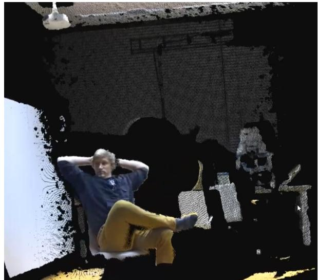
**Obrázek 4.** Vizuální výstup zařízení *Azure Kinect* bez hloubkové segmentace.
