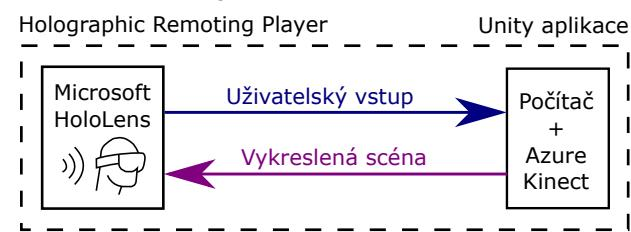
**Obrázek 5.** Detail komunikace brýlí HoloLens a počítače skrze *Holographic Remoting*.
