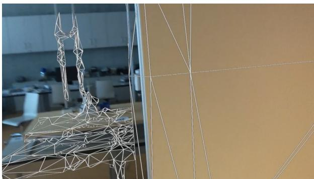
**Obrázek 6.** Vizualizace 3D trojúhelníkové sítě vytvořené pomocí prostorového mapování. Pohled z první osoby z brýlí Microsoft HoloLens.
